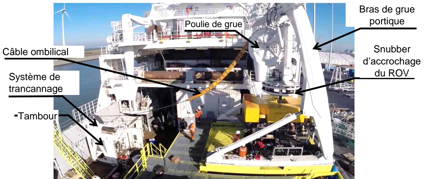
Figure 5 : photo de l'implantation de la grue et du tambour d'enroulement sur le pont du navire
