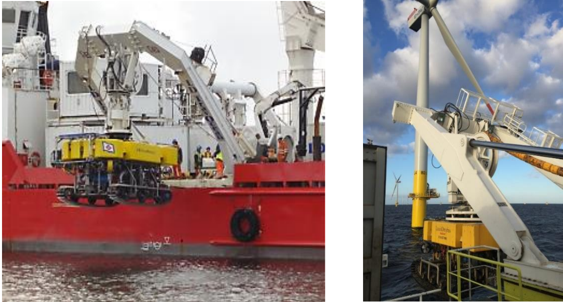
Figure 4 : ROV suspendu à la grue portique
