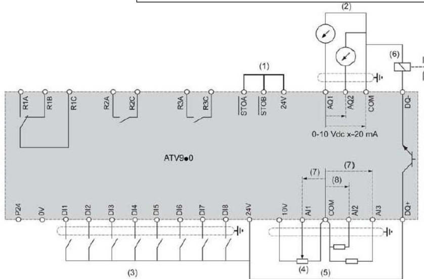
(1) STO arrêt sécurisé du couple , (2) sortie analogique, (3) entrée logique - les instructions de blindage sont données à la section Compatibilité électromagnétique (voir page 126) (4) potentiomètre de référence (ex. SZ1RV1002), (5) entrée analogique, (6) sortie logique, (7) 0-10 V DC, x-20 mA, (8) 0-10 V DC, - 10 V DC à +10 V DC.
