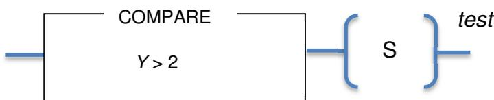
Si Y est supérieure à 2 alors mettre la variable *test* à l'état « 1 »
