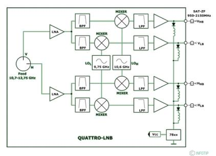
Un LNB transpose les signaux satellite polarisés Verticalement et Horizontalement de la Bande Entrante Satellite (BES: 10.7-12.75Ghz) dans une autre bande appelée Bande Intermédiaire Satellite (BIS: 950-2150Mhz), plus facilement transportable sur câble coaxial. Un LNB quattro permet la récupération sur ses 4 sorties des transpositions en bande BIS des bandes et polarisations suivantes:
