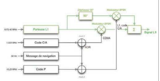
Afin d'identifier un satellite parmi les autres, les données transmises par chaque satellite sont associées à un code binaire pseudoaléatoire qui lui est propre (Code C/A). Ce code est constitué d'une succession de 1023 chips se répétant périodiquement. Il est transmis avec un débit de 1,023 Mchips/s.
