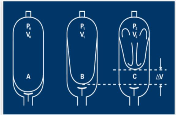
$V_0$  = Capacité en azote de l'accumulateur
