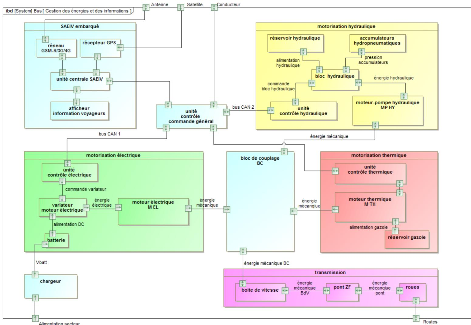
**DT5 : Schéma de principe de gestion des différentes énergies**
