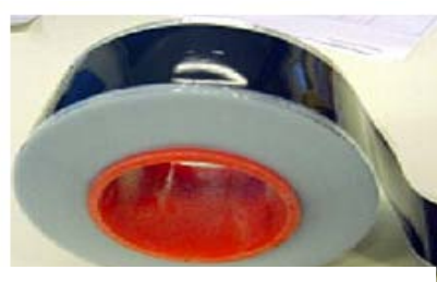
Film de cathode et d'électrolyte assemblés
