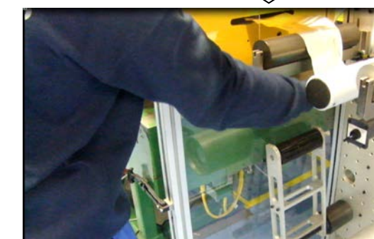
Prise en main de la bande de lithium en sortie d'extrusion pour début d'enroulement
