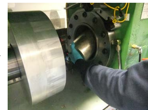
Mise en place du Cylindre « Bille » de lithium dans l'extrudeuse
