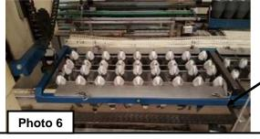
« Côté première zone d'encaissement Cadre centreur » : côté bouteilles non retournées Cadre centreur en « position basse » du centreur de bouteilles
