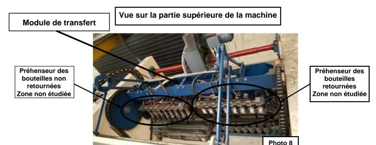
Autre point et non des moindres, elle permet de remplir un nombre de cartons important. Pour ce faire, l'encaissement des bouteilles se fait par groupe de quatre cartons, soit deux groupes de quatre cartons.
