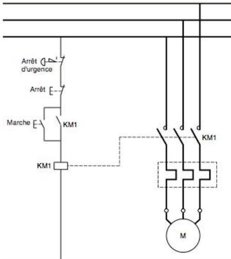
L'ordre issu du dispositif de protection (Arrêt d'urgence dans le schéma ci-contre) agit directement sur le contacteur puissance de la machine.
