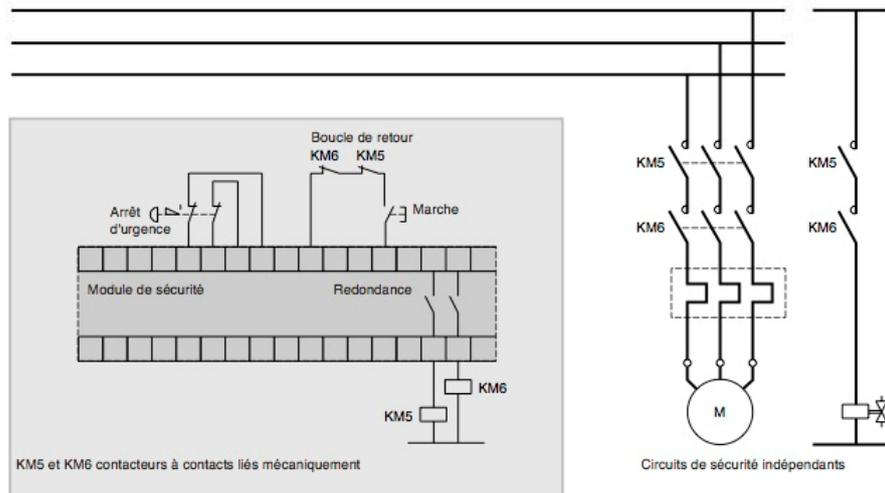
Les modules de sécurité permettent d'assurer un relaying intermédiaire fiable en éliminant les risques :
