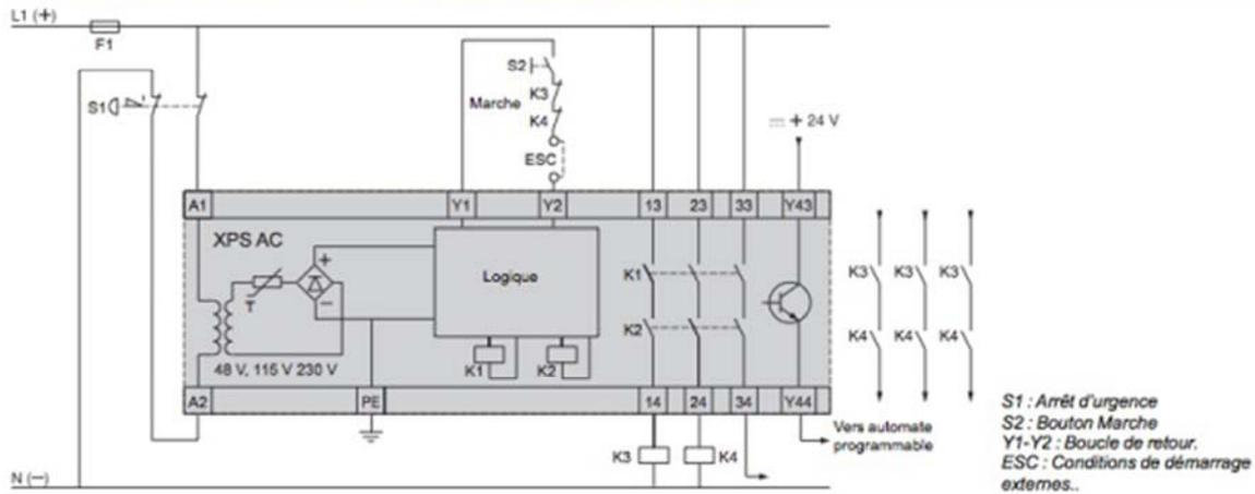
**Capteur de sécurité à manoeuvre positive et commande positive**
