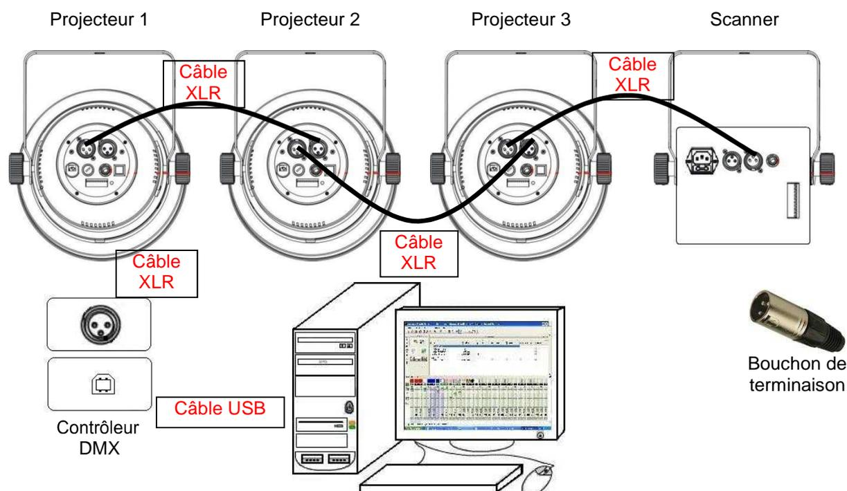
Pour relier les projecteurs entre eux, ainsi qu'au scanner, on utilise normalement des câbles de type XLR. Un câble réseau de type F/UTP, d'une longueur de 15 m, est déjà présent dans le faux plafond et pourrait permettre de relier le 1<sup>er</sup> projecteur à l'interface de commande, situé dans la régie.
