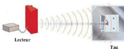
Le **tag RFID passif** : c'est une "étiquette" qui ne possède aucune source d'alimentation et qui est alimentée par le lecteur selon le principe de la télé-alimentation : le tag reçoit son alimentation par couplage électromagnétique. Lorsqu'il rentre dans le champ magnétique du lecteur, son antenne est parcourue par ce champ et ses circuits sont alimentés par un courant induit. Les 2 éléments sont en mesure de communiquer.
