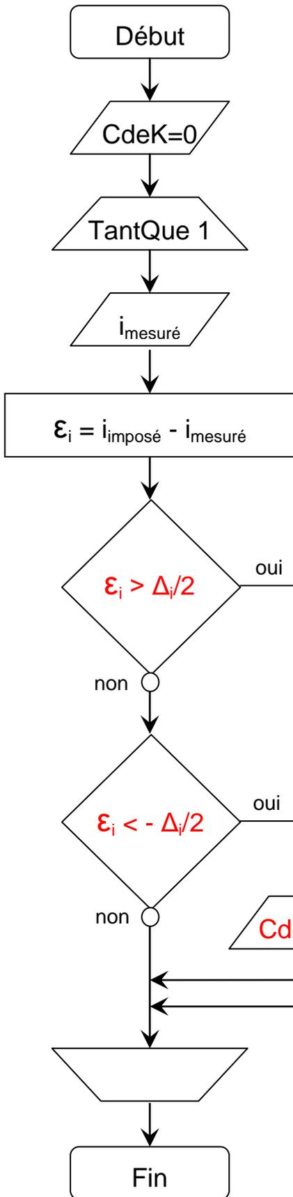
Initialisation de la commande de l'interrupteur statique K
