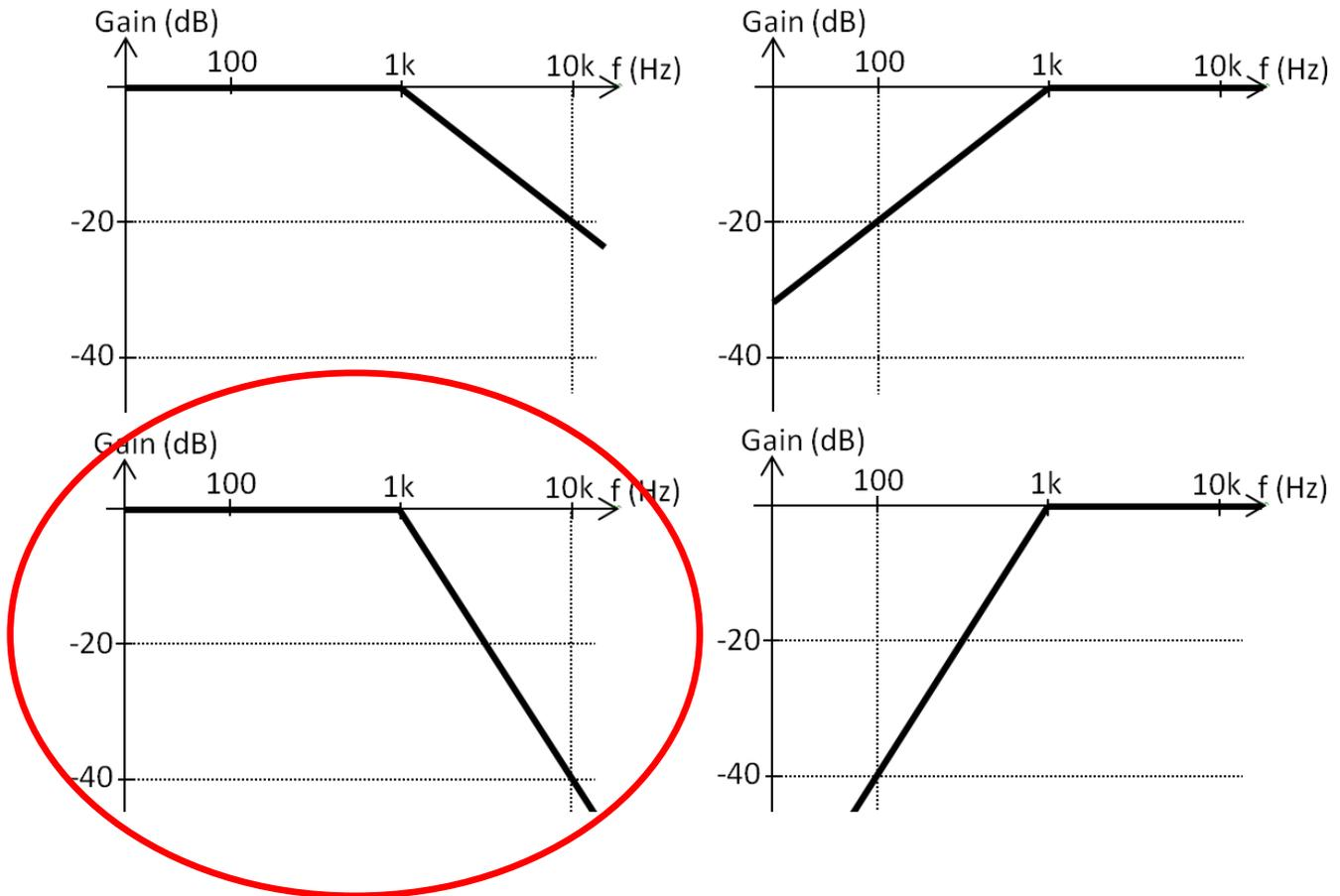
**Filtre passe-bas d'ordre 2, de fréquence de coupure 1kHz**
