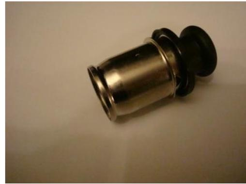
Les traitements de surfaces effectués consistent en un dépôt de **cuivre en milieu cyanuré de 6  $\mu\text{m}$**  d'épaisseur suivi d'un **nickel brillant également de 6  $\mu\text{m}$**  d'épaisseur sur les embouts en acier ; ceux-ci doivent être protégés contre la corrosion, résister à l'abrasion, et présenter un aspect esthétique.
