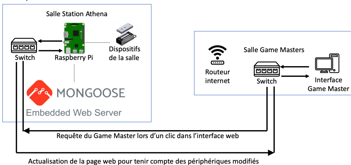
Figure C1 : communication entre le Game Master et la carte de commande.
