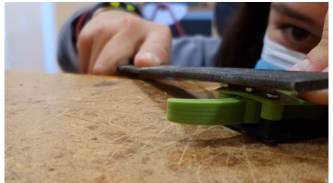
Limage des vis pour enlever un frottement
