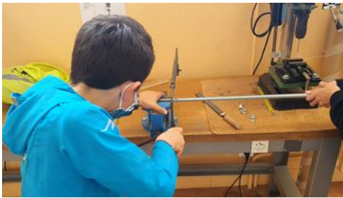
Sciage des tiges filetées.
